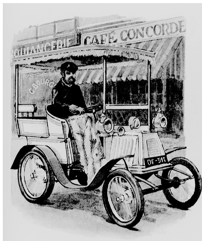
Voiture Renault en 1901 : puissance un cheval 3/4 pour une cylindrée de 273 cm 3 , avec radiateur d'eau placé derrière le moteur, signe distinctif de la marque.
