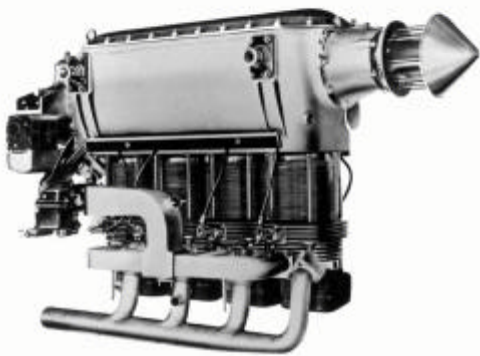
Moteur Renault 4-cyl inversés type 4 Pci de 100/110 ch (1932). (Musée Renault).
