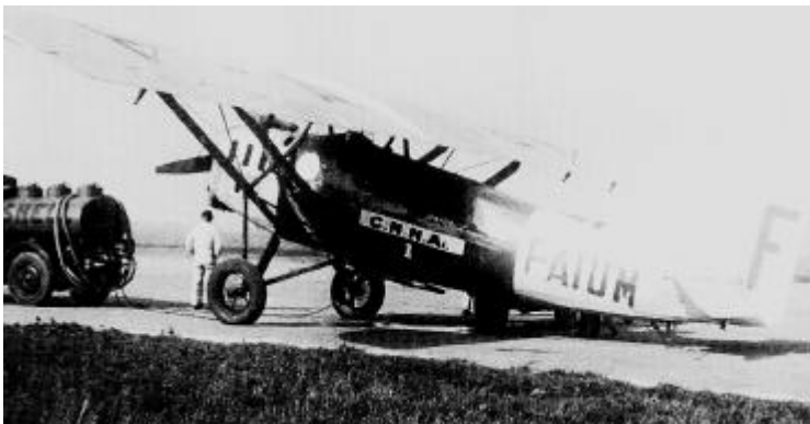
Latécoère 25 à moteur Renault 12 Ja de 450 ch (1928).
