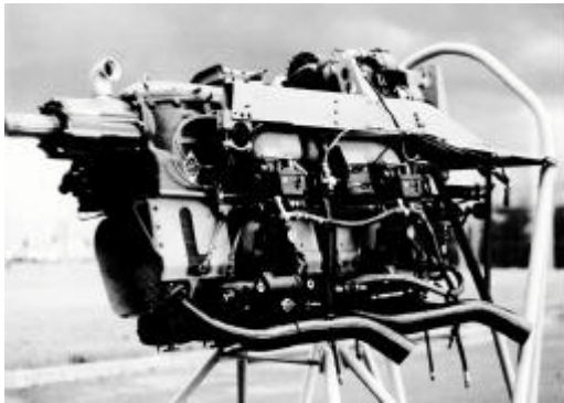
Moteur Renault 6Q de 220 ch restauré par le Musée SNECMA de Villaroche en 1987. (Musée SNECMA).
