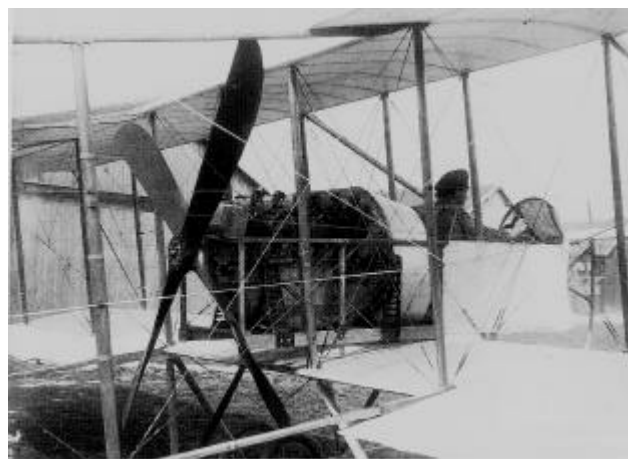
Le premier Renault V12 d'aviation, en 1912, monté sur un biplan Maurice Farman. (Musée Renault).
