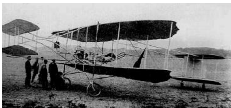
Le biplan Sanchez-Besa (1911) à mâturation métallique fut le premier à monter le V12 Renault de 90 ch. (Archives mun. de Boulogne-Billancourt).
