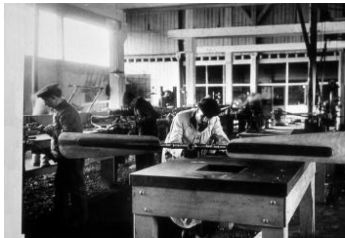
Ateliers Voisin de Billancourt, 1908, fabrication des hélices d'avions. (Archives municipales de Boulogne-Billancourt).
